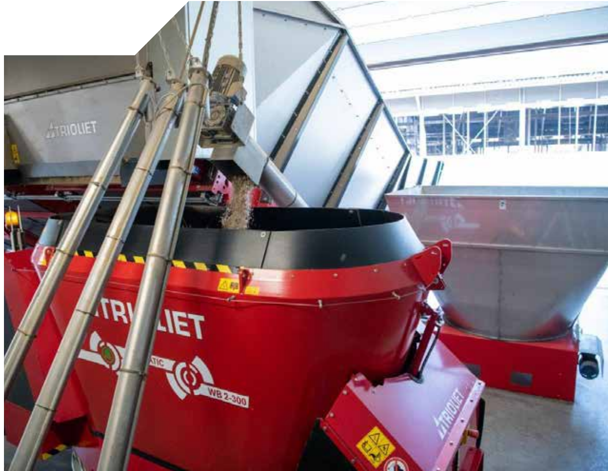
RVS vijzeldoseerbunker met roeder, dwarsafvoervijzel en opvoervijzel
