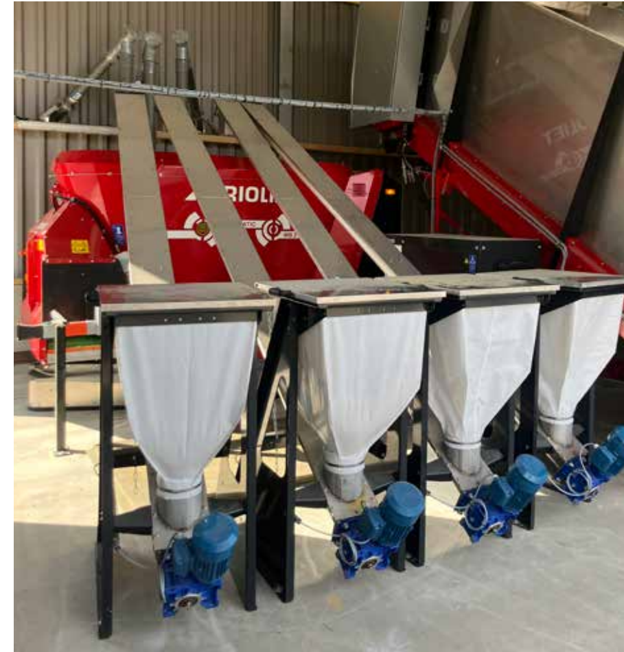
Mineralendoseerder met 120 L opslagzak en RVS trogvijzel
