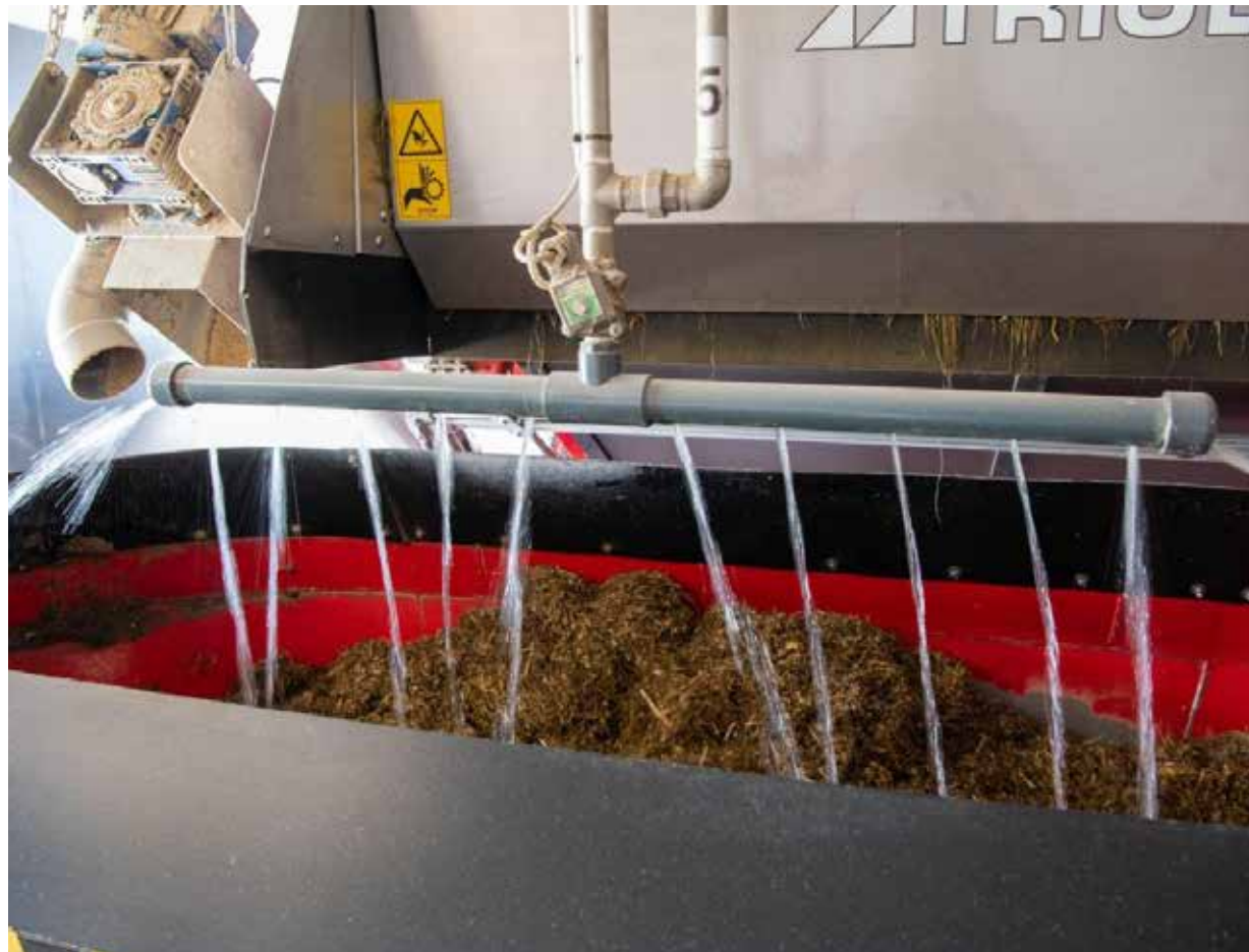
Watertoevoersysteem compleet met sproeiboom 1 m.
